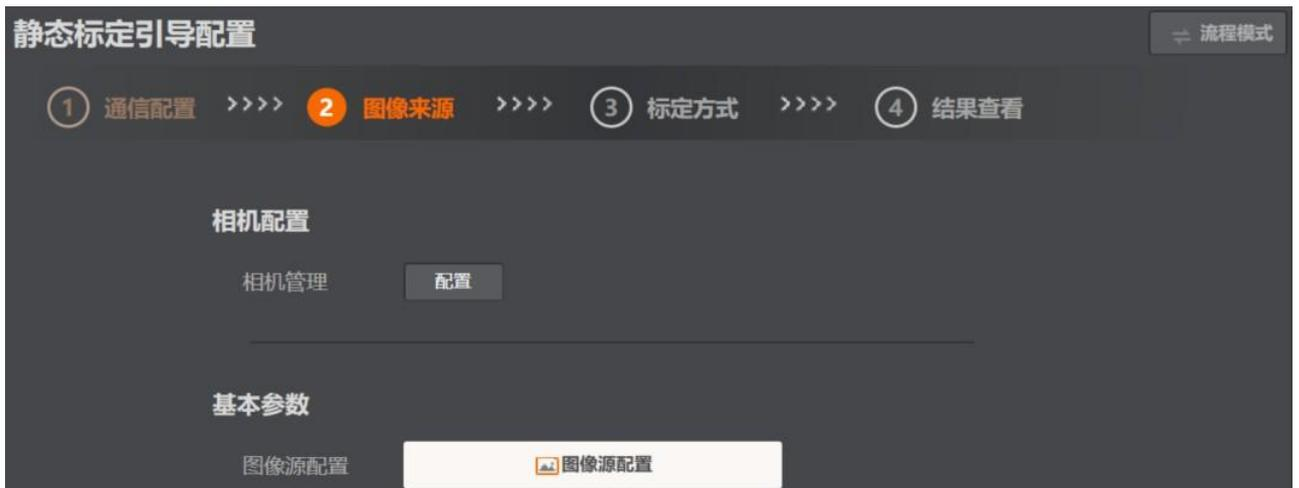
点击配置可添加全局相机，点击图像源配置，设置图像源模块的相关信息。可选用本地图像、相机图像、SDK，点击右下方下一步。
