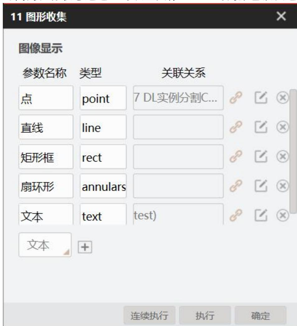
支持通过订阅脚本模块输出自定义图形，图形数据通过脚本实现。当图形收集模块放在Group模块中使用时，若Group模块设置循环，该模块可将每次循环收集的图形叠加显示。若设置的图形订阅的“目标状态”为空或未订阅时，直接输出订阅的“区域”。
