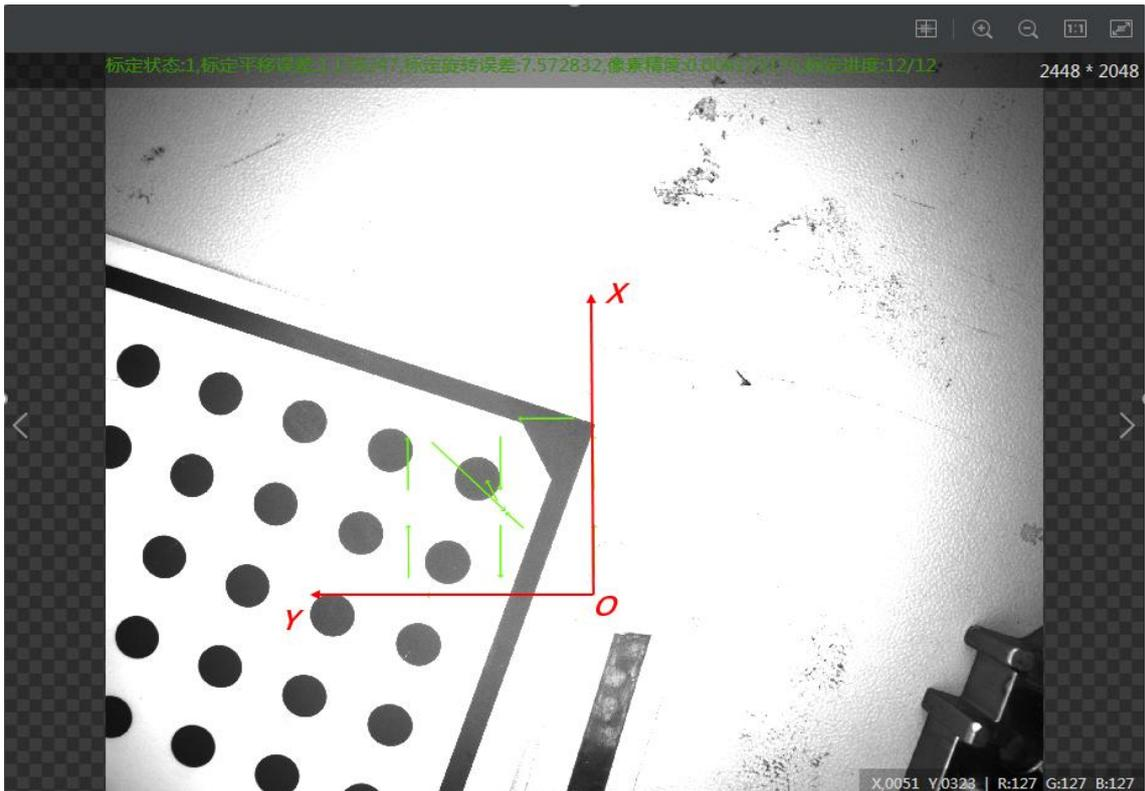
在坐标系中，从X正方向向Y正方向转动角度为正，反之角度为负，如下图所示。
