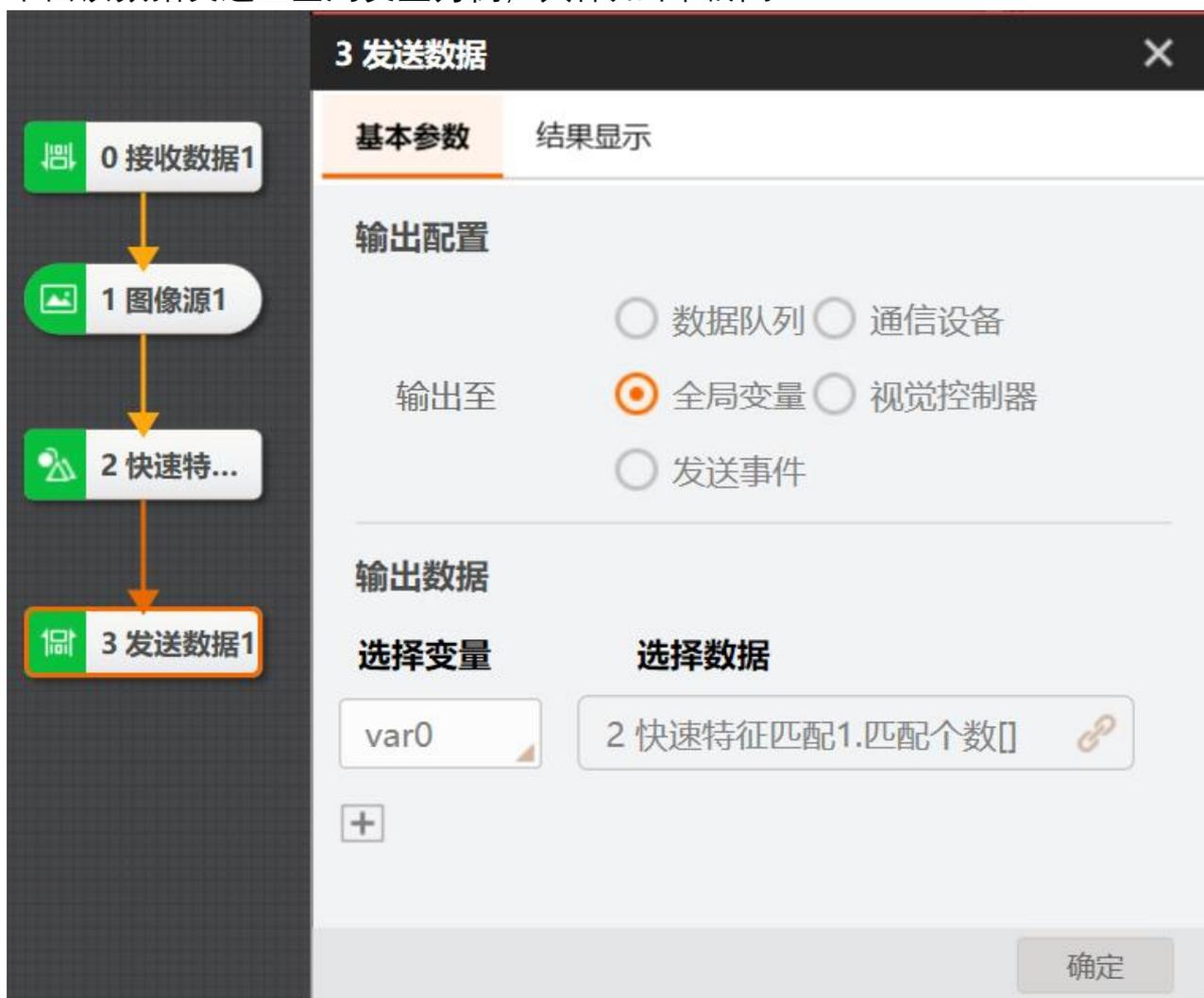
在输出配置中选取输出至全局变量，在输出数据中选择目标全局变量，在选择数据中订阅需要发送至全局变量的数据，将数据发送至全局变量后，可在方案中使用接收数据模块订阅全局变量中的数据，从而获取由发送数据模块发送而来的数据。
