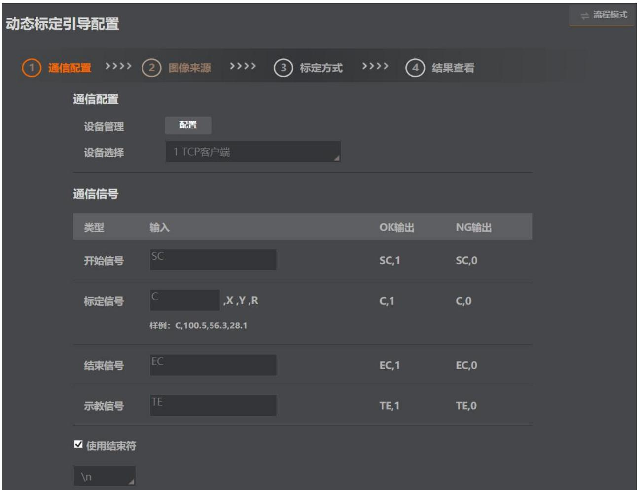
2、通信配置完毕后点击界面右下方下一步按钮，对动态标定图像来源进行选择，点击相机管理创建全局相机，点击图像源配置选择全局相机作为图像来源，配置好相机参数后点击界面下方下一步按钮进行标定方式的选择，详情如下图所示。
