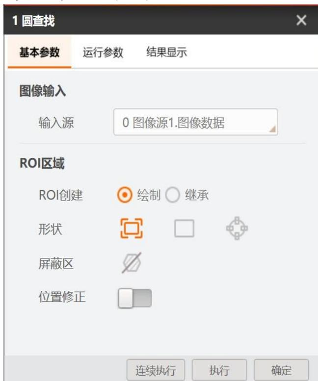
图像输入：选择本工具处理图像的输入源，可根据自己需求从下拉栏中进行选择。
