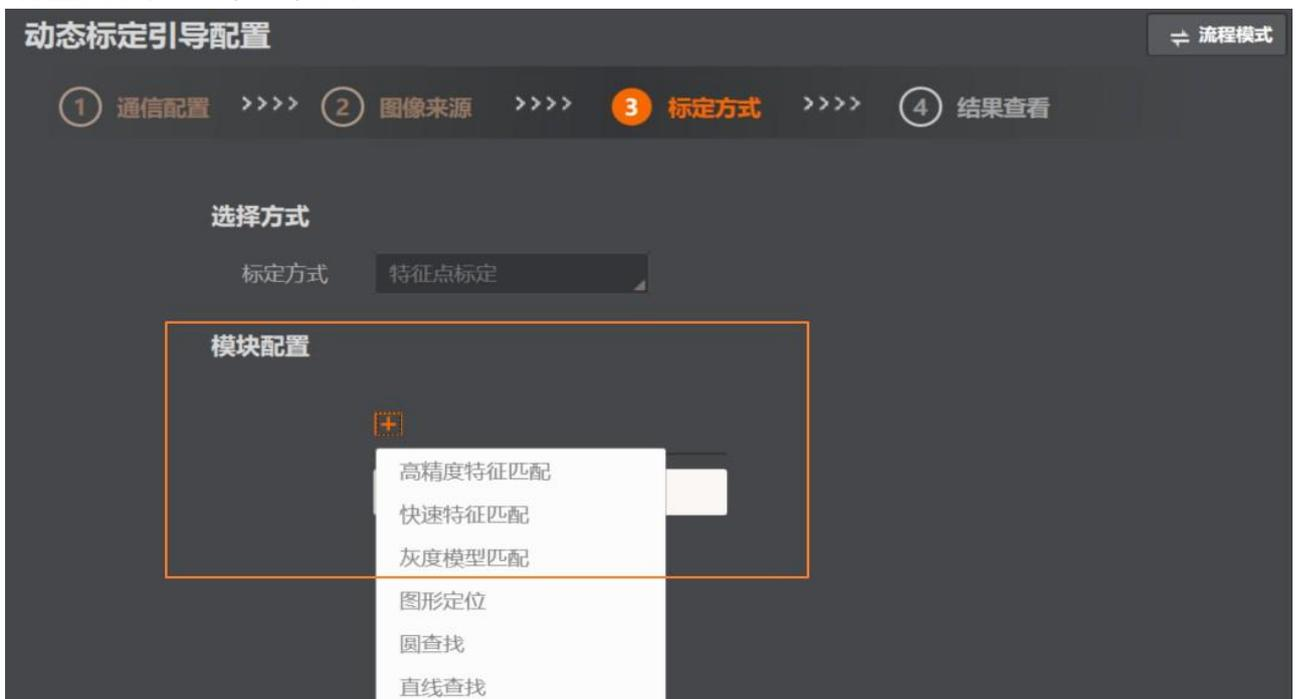
点击 **+** 订阅获取N点标定模块中的物理点以及图像点，一般选择订阅快速特征匹配，配置完成后选择界面右下角点击下一步按钮进入最后一步结果查看。
