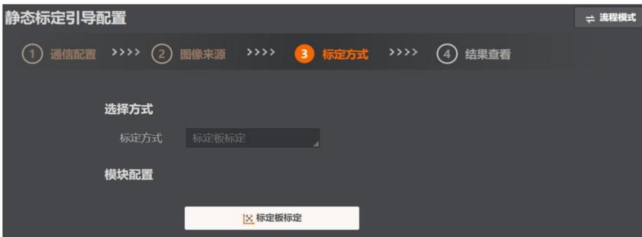
点击标定板标定可以根据实际应用情况对标定板标定模块参数进行配置，具体配置方式请详见[标定板标定](#)章节。参数配置完成后关闭标定板标定模块，点击右下角下一步。
