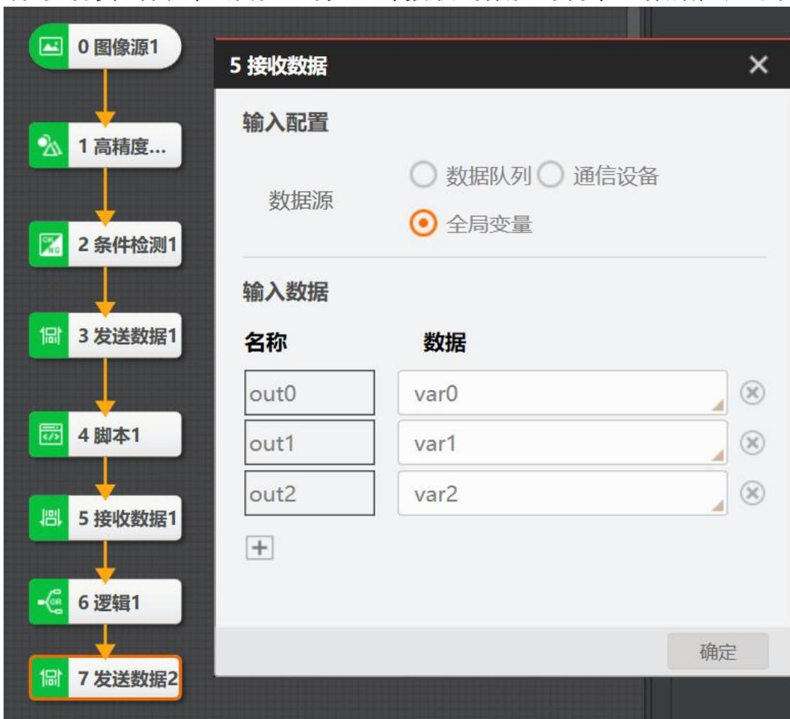
最终对接收到的所有数据进行逻辑与运算，并将运算结果通过TCP通信输出给第三方设备。
