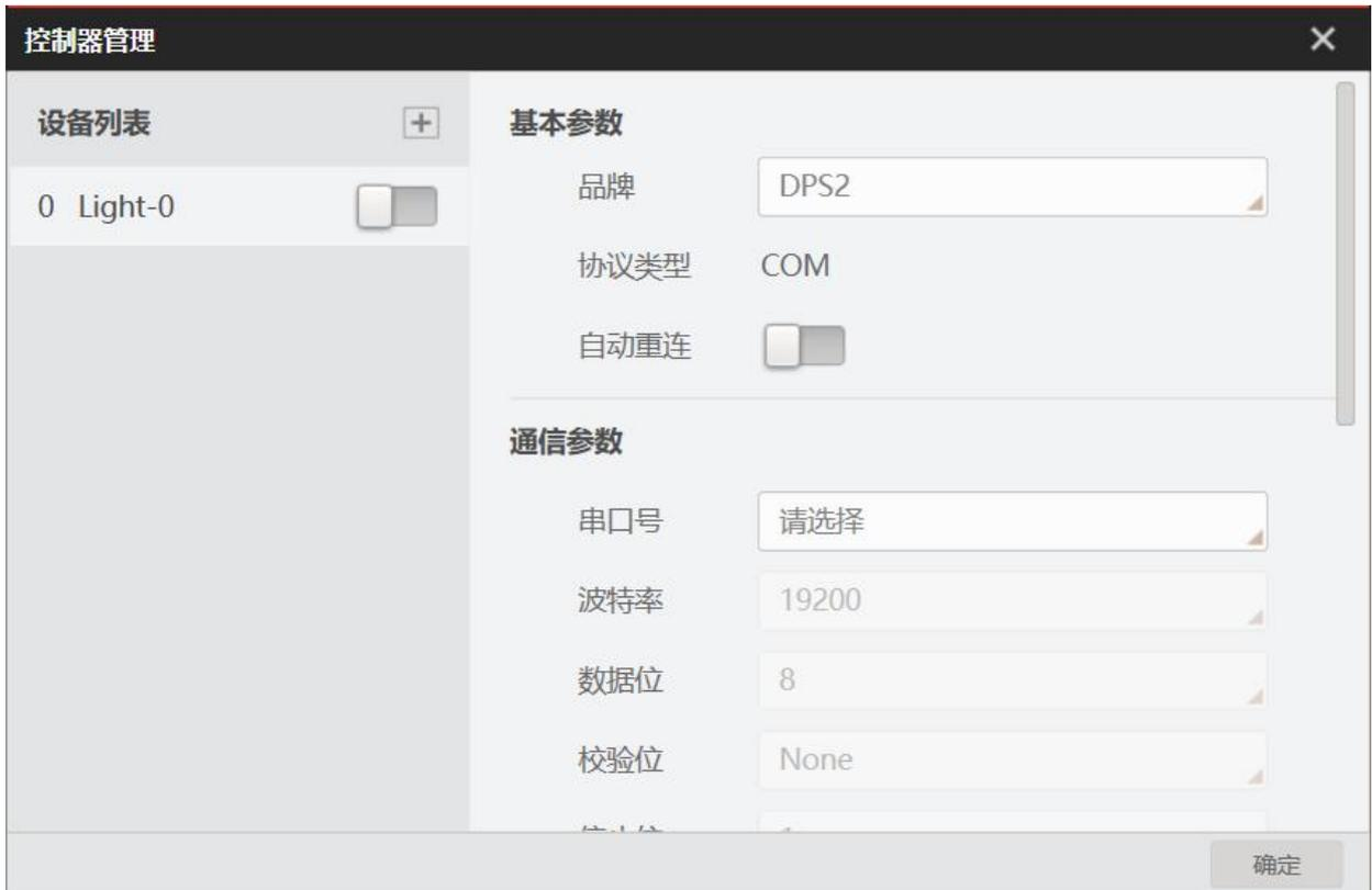
添加控制器后，首先需完成基本参数的设置，再对不同品牌控制器设置通信参数、光源参数和IO参数。
