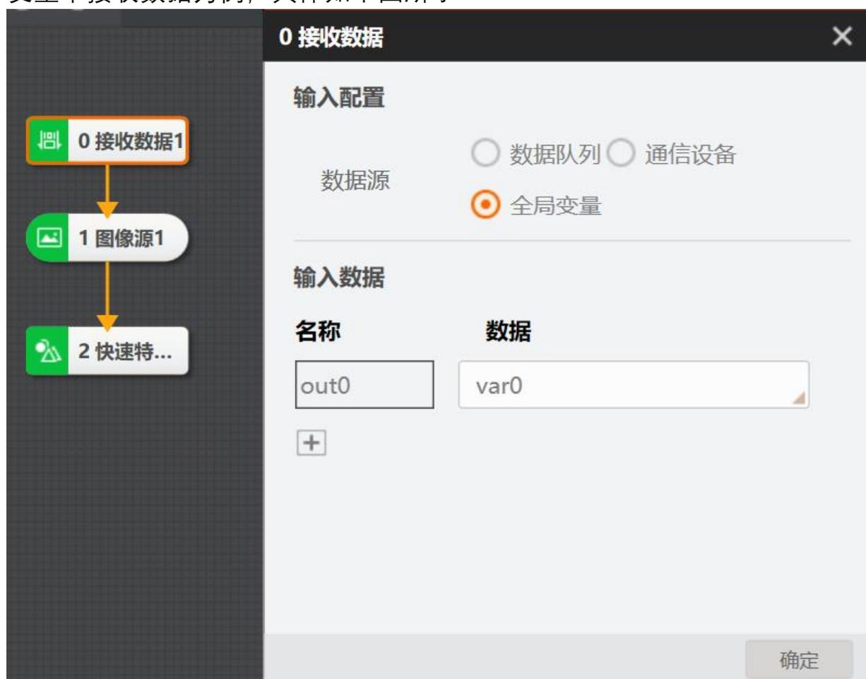
在输入数据中添加数据名称，以及订阅数据来源，如上图所示接收数据模块从全局变量中获取了流程1发送至全局变量的数据，由格式化模块订阅接收数据的信息即可将流程1的数据在流程2中显示。
