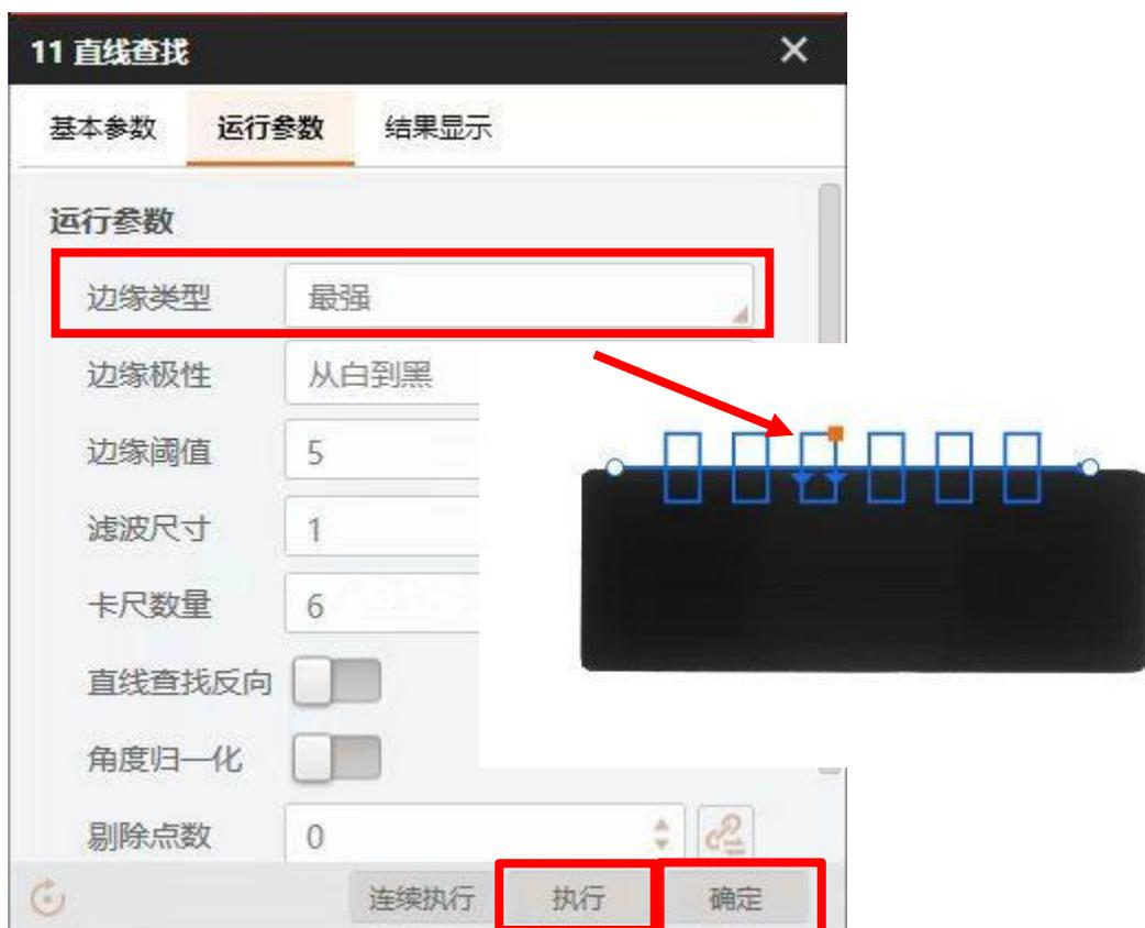
在左侧任务栏中再拖出一个直线查找模块，连接位置修正和直线查找
