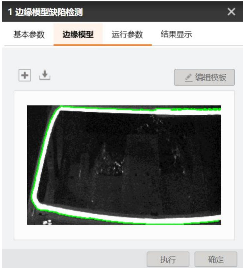
建模完成后配置相应的运行参数，运行后会输出相应的缺陷信息，如下图所示。
