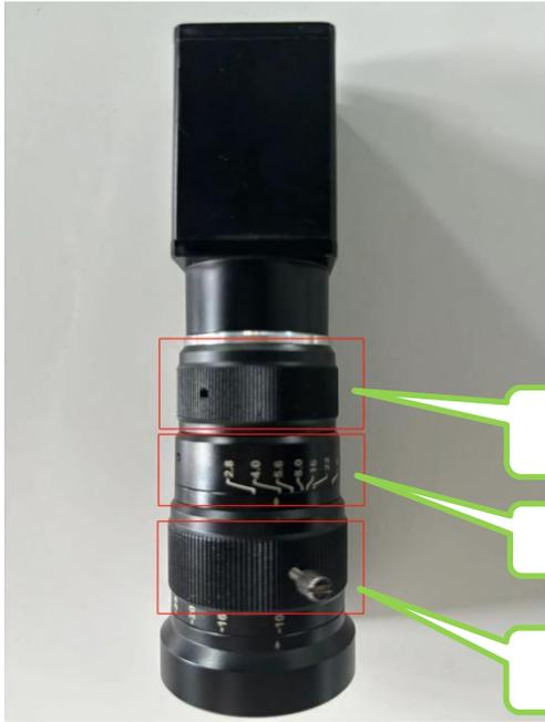
旋转相机镜头上的焦距旋钮，调整合适的视野大小，然后旋转相机镜头上的对焦环旋钮、光圈旋钮，调整光圈大小、对焦直至画面清晰，调整完后记得锁紧镜头上的螺丝，防止误碰
