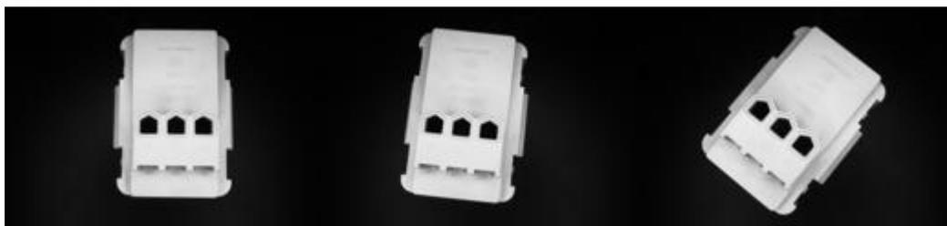
当拍摄到的物体在视野中发生了位置偏移时就需要对图像进行纠偏，保证定位处理的准确性。图像修正中的修正信息可以从位置修正中传入，建议使用标准图像建立模板来保证修正信息的准确性，如下图所示。
