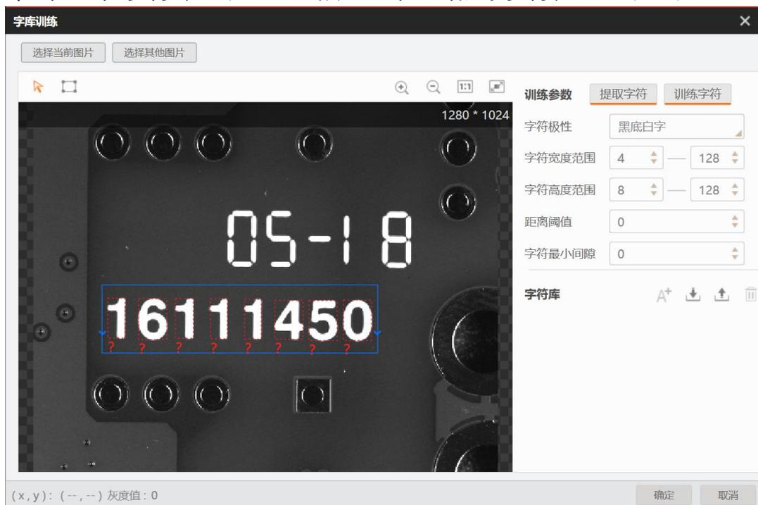
单击“训练字符”，自己输入对应的字符真值，全部添加至字符库即可完成训练，若识别不准确可重复训练，在字符库里面选中单个字符点击
