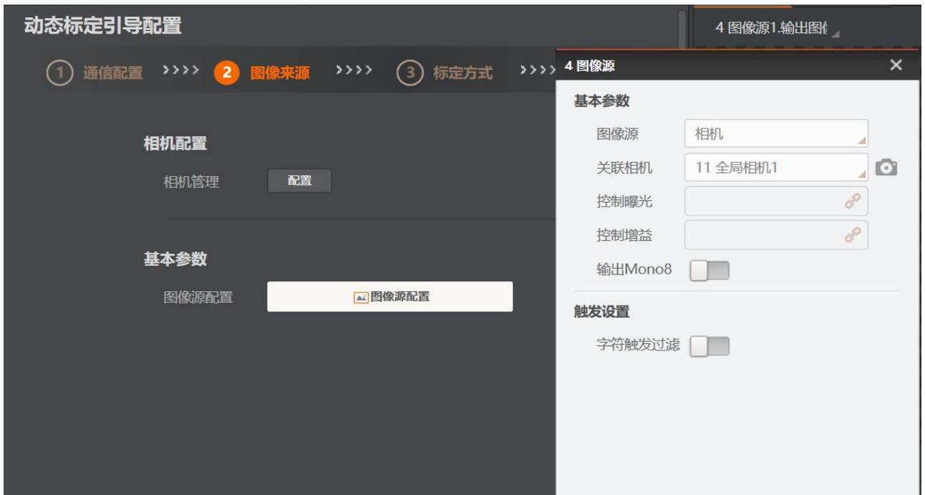
3、选择标定方式，动态标定中支持N点标定和N图像标定，同静态标定类似，其标定方式包含特征点标定以及标定板标定两种选择，且N点标定参数配置方式请参考[N点标定](#)章节，N图标定参数配置方法请参考[N图像标定](#)章节，标定方式选择标定板标定时仅需配置N图像标定模块参数即可，特征点标定时配置方式如下图所示。
