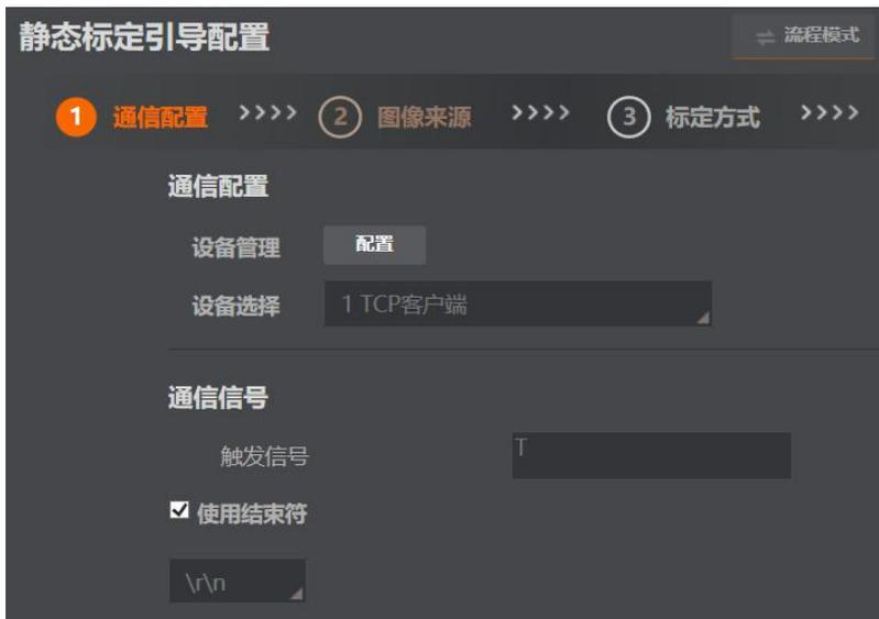
点击‘配置’进入通信管理选择并添加通信工具，点击设备选择根据实际情况选择通讯设备；通过通信信号设置触发信号，通过发送触发信号完成流程的执行。若需要使用结束符，则勾选后，下拉选择具体内容。点击右下方下一步。
