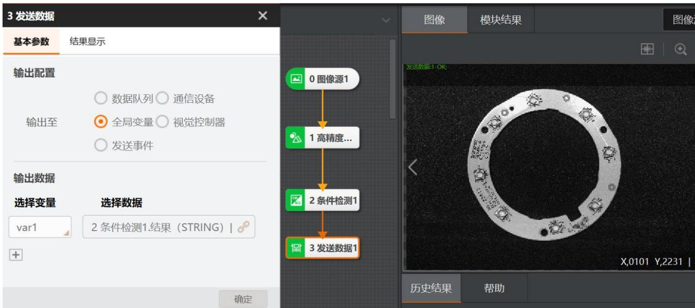
可以在任意流程的后面接收全局变量的结果并做相应的逻辑运算，但是要控制好时序，保证在所有全局变量都接收到数值时再取出数据，如下图所示。
