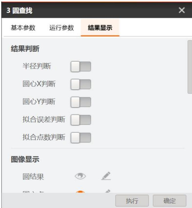
结果判断：对算法输出结果进行判断，判断结果会对模块状态造成影响。以半径判断为例，开启半径判断则可设置目标圆的半径范围，默认0~99999，当查找的圆半径在参数范围内圆轮廓会显示绿色，超出会显示红色。
