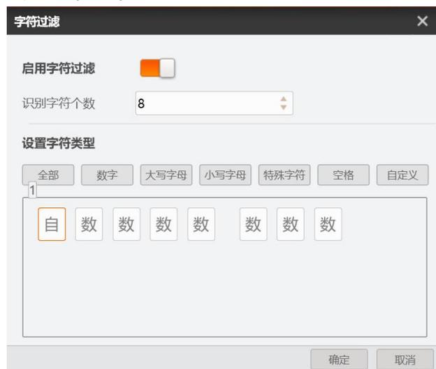
当启用字符过滤后可以自定义识别字符的个数以及每个字符的类型，有全部、数字、大写字母、小写字母、特殊字符、空格、自定义等几种类型，可以通过“自定义”定义容易误读的字符，但前提是自定义的字符要存在于字符库中。
