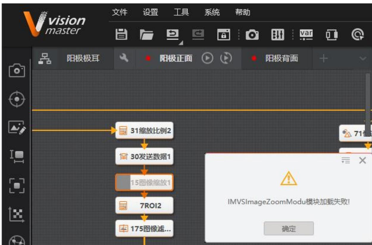
加载失败的模块和其他模块样式有所不同，模块名称和左侧图标部分均呈现灰色，例如图中的图像缩放模块。
