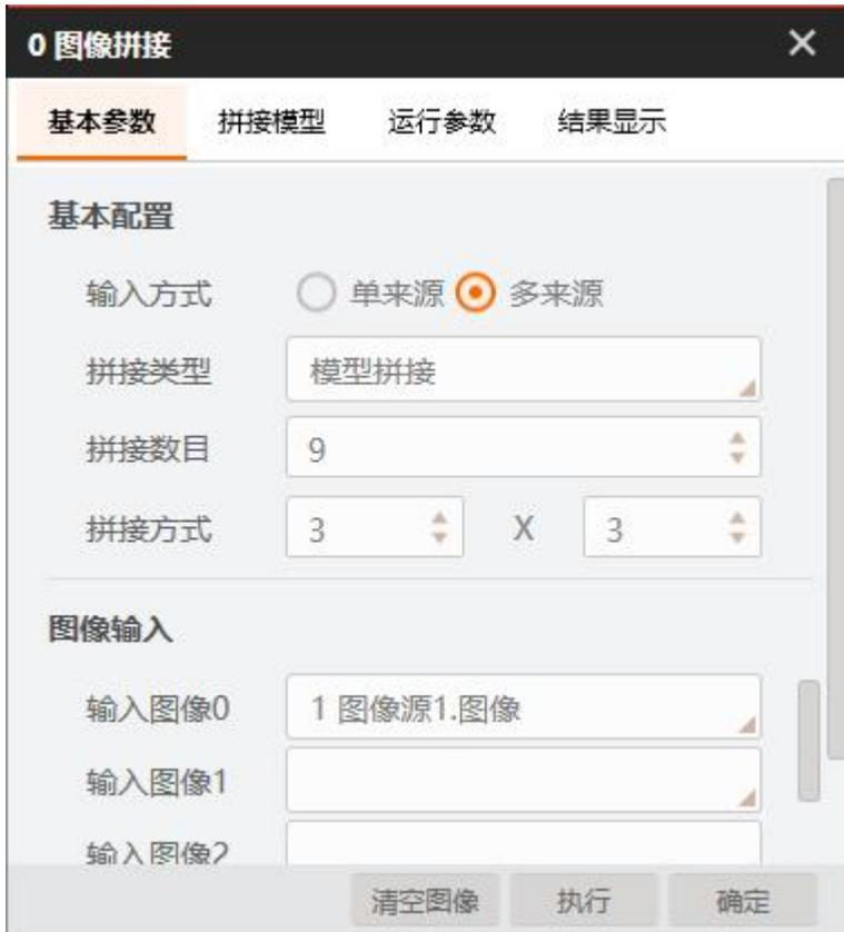
拼接模式选择硬拼接时，直接按照设置的参数进行拼接；拼接模式选择模型拼接时，需要新建模型。
