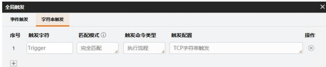
通过TCP通信发送字符串“Trigger”即可触发对应的流程运行一次。
