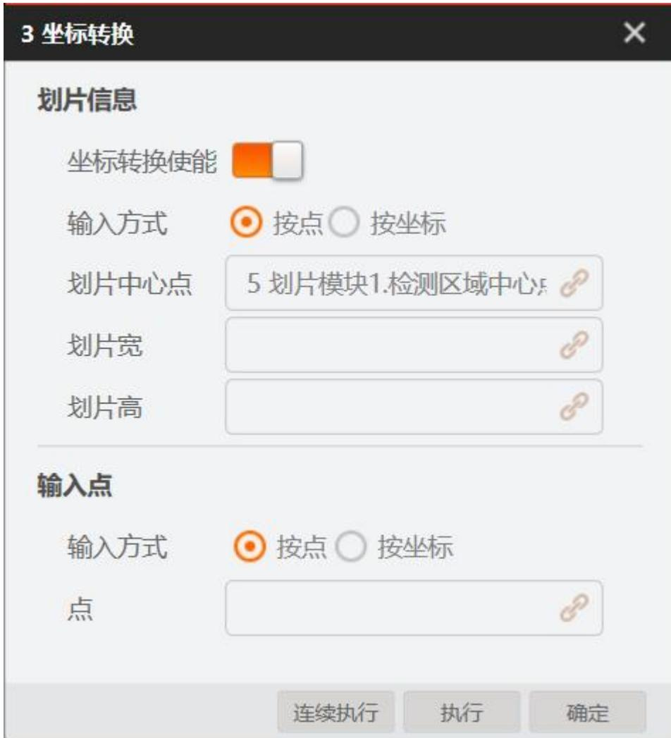
若不启用坐标转换使能，则输入点的数据和输出点的数据完全一致。
