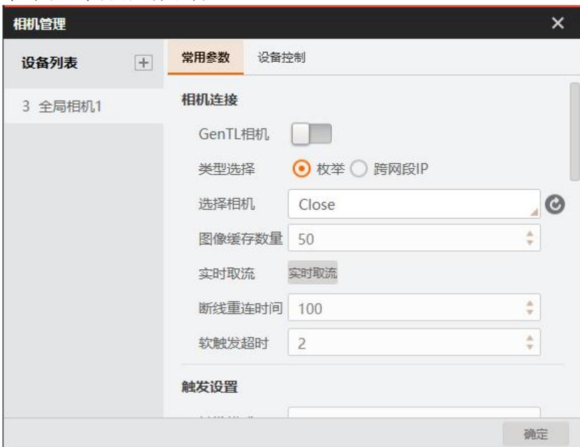
添加相机时需选择相机类型，可选**相机**、**Dalsa图像采集**或**迈创采集**。选择**相机**时，可通过cti文件连接各类相机，也可直接连接网口、USB口相机。需设置常用参数和触发参数，具体请见下表。
