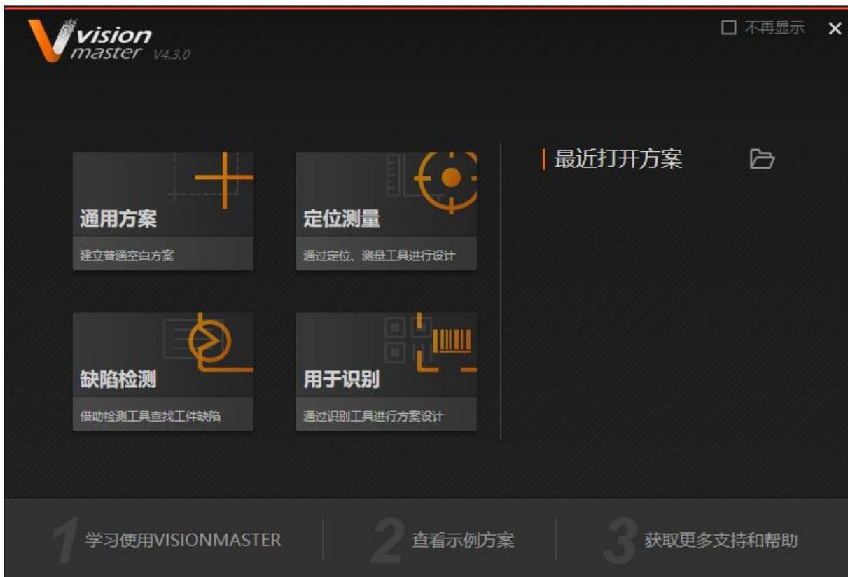
方案类型选择：包含“通用方案”、“定位测量”、“缺陷检测”、“用于识别”四个模块，其中通用方案包含后三个模块，用户可根据所需方案编辑类型进行选择。
