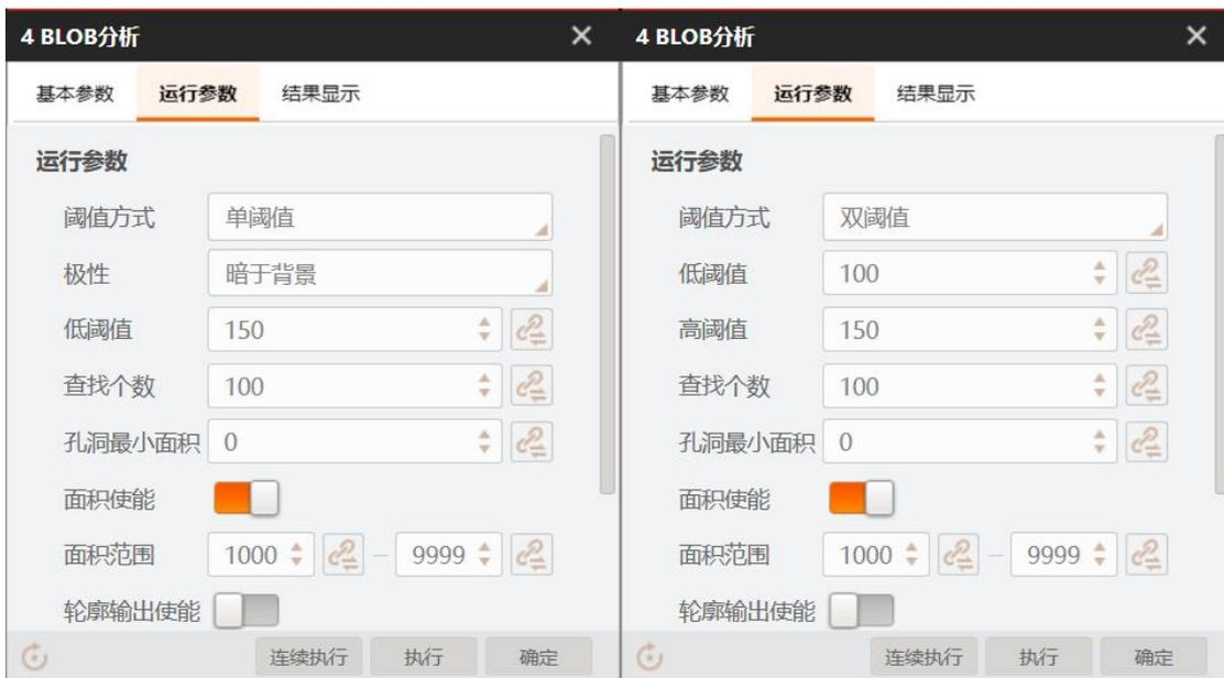
将鼠标指针放到脏污表面，右下角RGB显示的数值为100，所以脏污的灰度值100左右，因为产品表面为白色，所以参数设置只需要选择单阈值、暗于背景、低阈值为150，也就是在产品表面识别灰度值比150低（脏污灰度值为100左右）的图像特征。如果对面积有限制也可以在参数设置中的面积范围设置面积大小。
