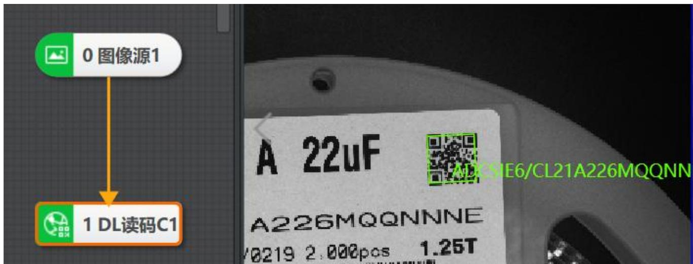
在基本参数模块中可进行ROI区域绘制操作。对于ROI区域，鼠标移动至矩形框的四个角均会显示白色旋转图标，左键按住并转动即可旋转该ROI区域。
