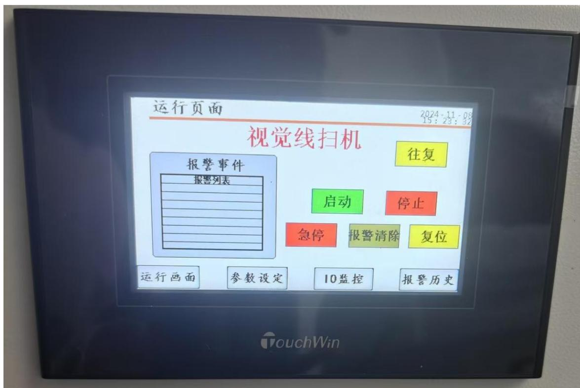
点击参数设定就会跳转这个页面，先将平台复位，扫描正转和反转功能才能正常使用，可以根据读取当前位置来设定扫描起点和终点，相机开始位置是行程到了方位会有触发信号
