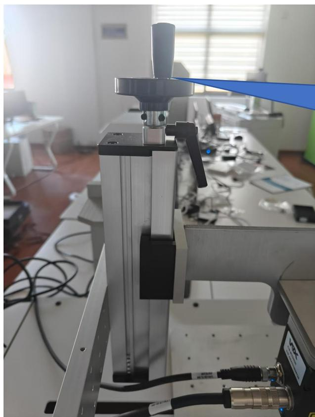
旋转调整相机高度（若产品放到相机下无图像显示时调整相机高度）
