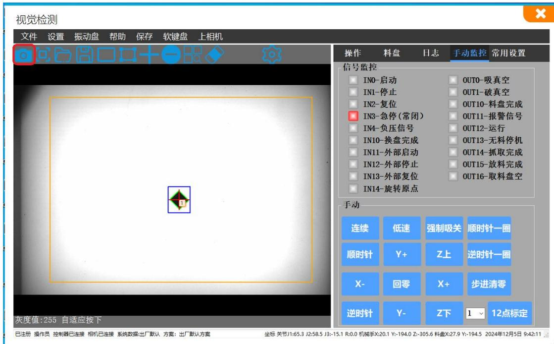
模板建立好后，点击“料盘”栏左侧的“操作”栏，点击“操作”栏最下面一排第一个按钮“使能中”将机械臂使能断开，将机械臂拖动到并针刚好贴到产品表面后点击去料高度一栏最右侧的录入按钮
