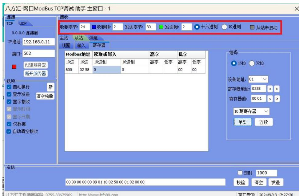
连接到蜘蛛手后我们把视角移到接收栏，依次点击左上方红框内的的“主站”>“寄存器”。然后填写右侧编码栏内的数据，选择16位，设备编码为1，寄存器地址启动指令为600（停止则是601）转换为16进制则为0258（0259）寄存器地址可以在蜘蛛手左上角设置中找到通讯设置查看，寄存器数改为1，选择写寄存器即可发送命令给蜘蛛手，后续在图中紫框部分输入“1”“0”可控制蜘蛛手的启停。
