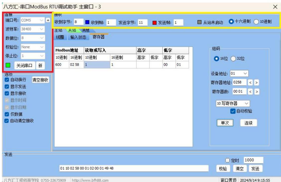
连接到蜘蛛手后我们把视角移到接收栏，依次点击左上方红框内的的“主站”>“寄存器”。然后填写右侧编码栏内的数据，选择16位，设备编码为1，寄存器地址启动指令为600（停止则是601）转换为16进制则为0258（0259）寄存器地址可以在蜘蛛手左上角设置中找到通讯设置查看，寄存器数改为1，选择写寄存器即可发送命令给蜘蛛手，后续在图中紫框部分输入“1”“0”可控制蜘蛛手的启停。
