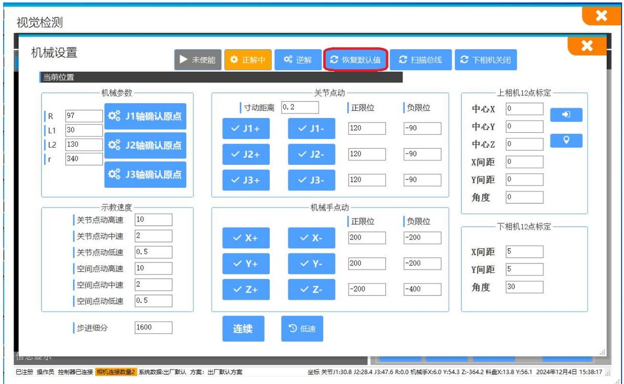
然后将小水平仪放置到振动盘上方置零，再放置到机械臂上方通过绿色框内的“J1+J1-”等点动的方式将机械臂与振动盘之间做到相对水平，当一个轴水平后点击红色框内该轴对应的“确认轴原点”。
