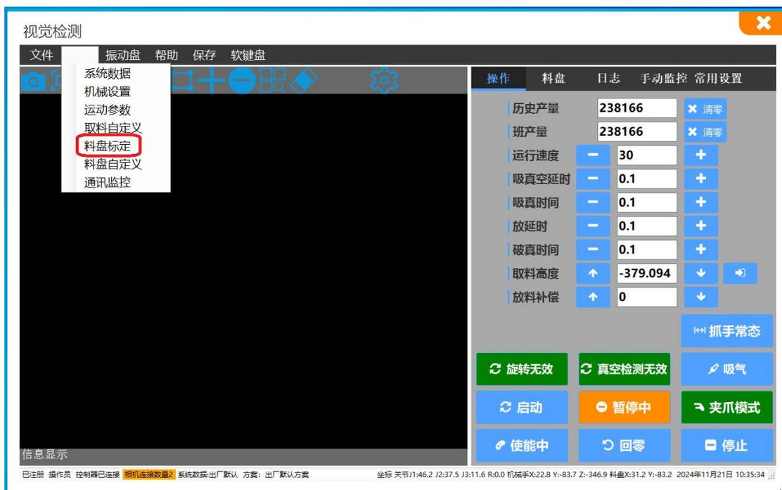
进入料盘标定界面之后，将标定板放到料盘上，手动拖动蜘蛛手移动到标定板上的孔洞上方点击“载入”按照下图所示顺序
