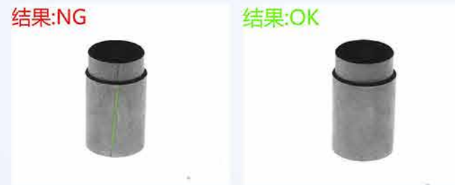
• 咖啡机内部金属管有无裂缝
