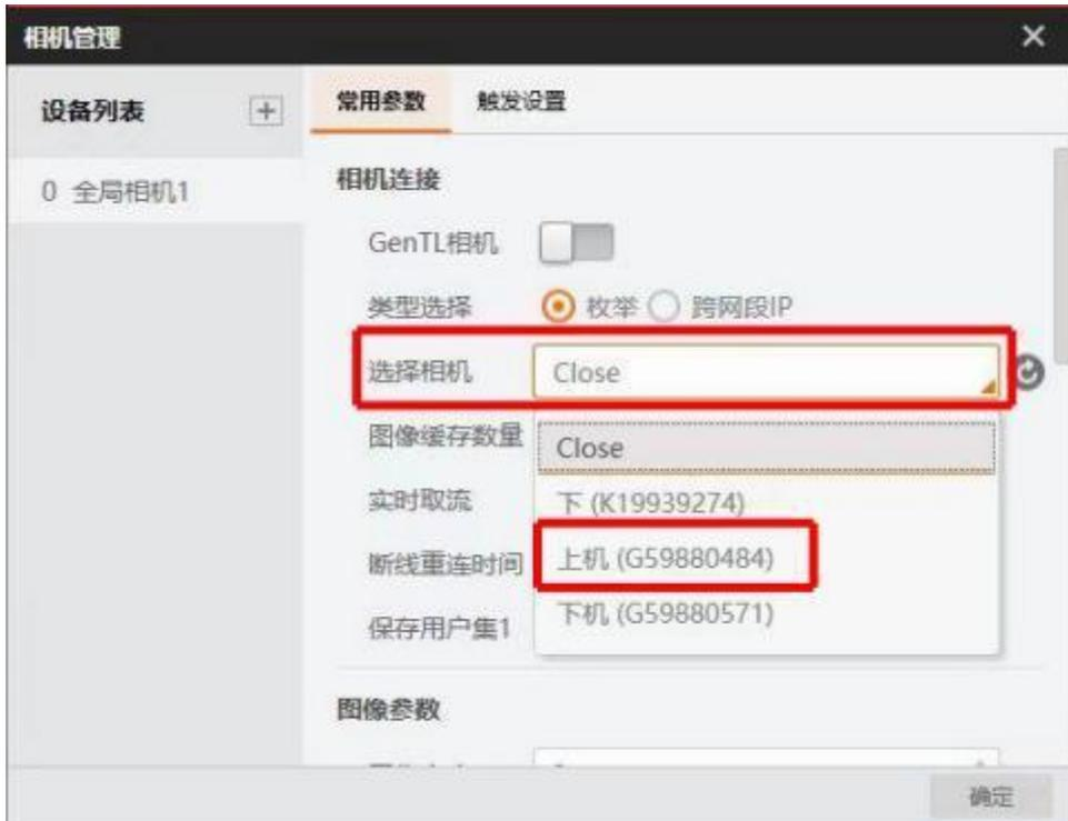
点击触发设置，把触发源改为 SOFTWARE（软触发），关闭相机管理窗口
