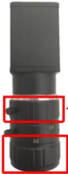
旋转相机镜头上的光圈旋钮和焦距旋钮，调整光圈大小和焦距，直至画面清晰，调整完后记得锁紧镜头上的螺丝，防止误碰
