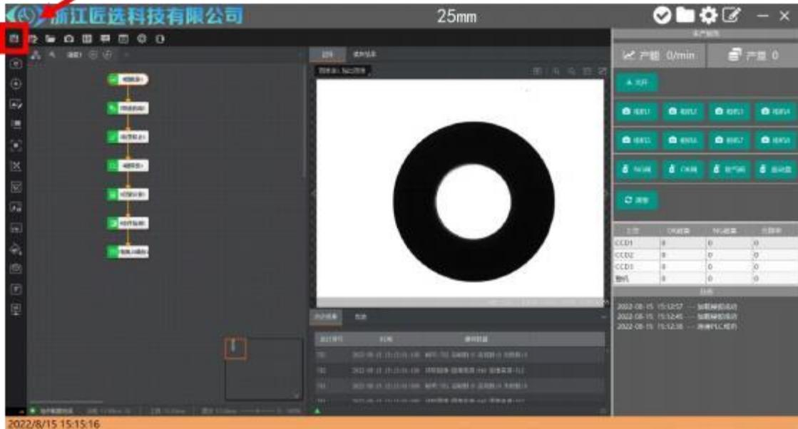
还有第二台相机就在相机管理中添加一个相机，再添加一个流程，重复以上的操作，（流程下图像源里的相机对应相机管理中的相机，有几台相机就添加几个流程）
