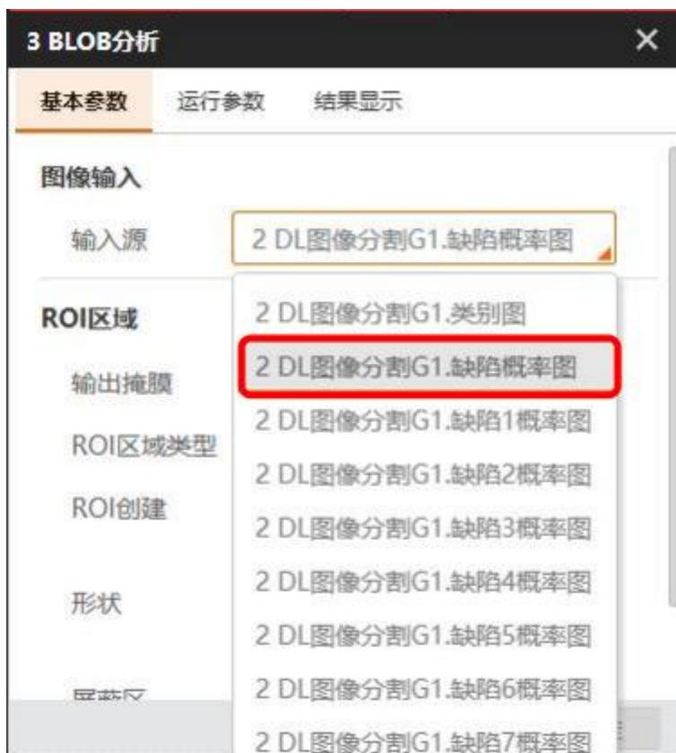
选中缺陷概率图，然后放一个瑕疵品去跑，白色地方为瑕疵处，然后点击输出图像，位置对比，看看深度学习效果有没有误判，将鼠标移到白色地方，图片右下角有阈值数值，如果误判处阈值跟瑕疵处阈值相差大(相差30以上为大)，打开blob分析的运行参数，极性选择亮于背景，低阈值的参数为瑕疵处阈值减十。如果误判处和瑕疵处阈值接近，请重新深度学习打标，误判处在打标的时候进行屏蔽(参考第76页)
