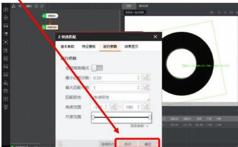
在左侧任务栏中找到并拖出**位置修正**模块，连接快速匹配与位置修正
