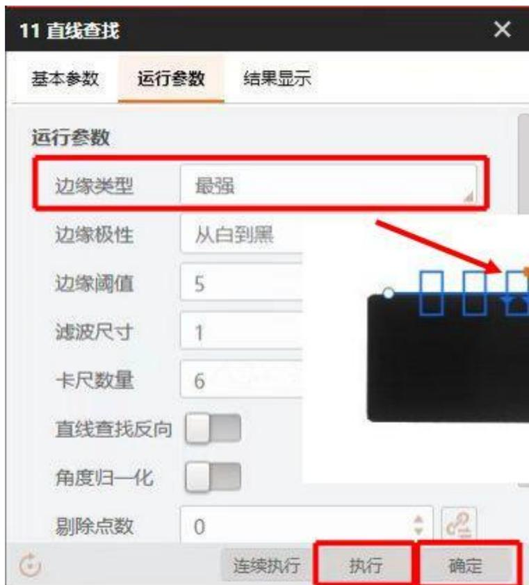
在左侧任务栏中再拖出一个**直线查找**模块，连接位置修正和直线查找
