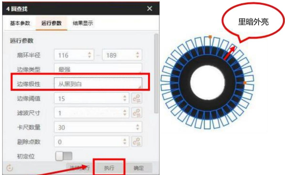
点击执行后，就会找到以点组成的圆，如（果执行后画的圆有所移动，再重新画一下即可）以及圆的各个参数，点击确定
